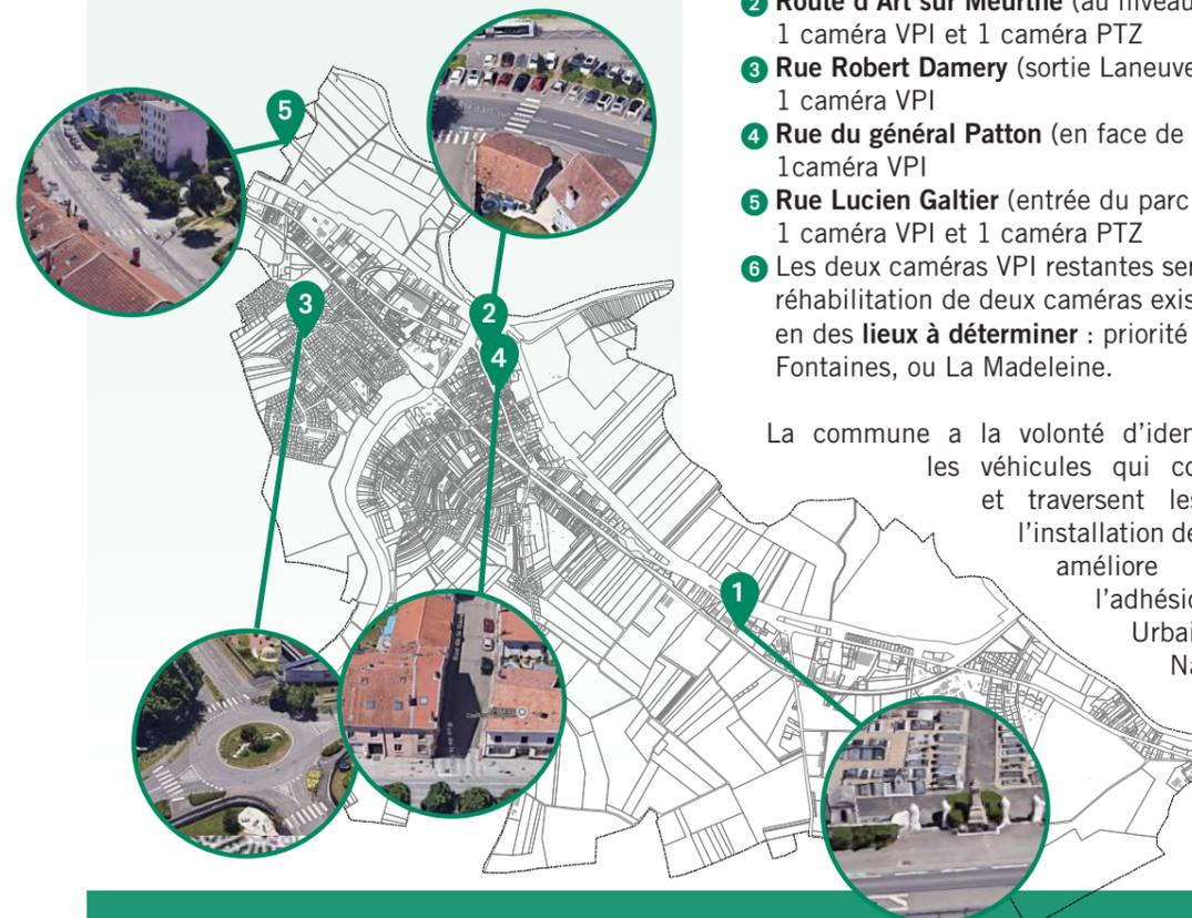
La commune a la volonté d'identifier via les caméras VPI les véhicules qui commettent des infractions, et traversent les axes structurants. Avec l'installation des caméras PTZ, la commune améliore la vidéoprotection, avec l'adhésion au Centre de Supervision Urbain de la Métropole du Grand Nancy, qui garantira un visionnage en temps réel des caméras de 18h à 6h, 7 jours sur 7, 24h sur 24.
